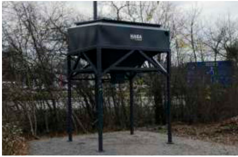
HABA silo de arena
